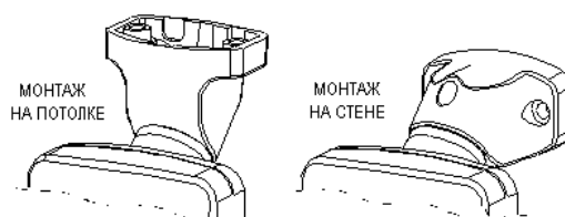
Рисунок 6. Крепление кронштейна на потолок и на стену
