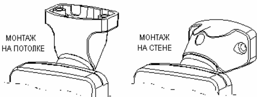
Рисунок 7. Крепление кронштейна на потолок и на стену
