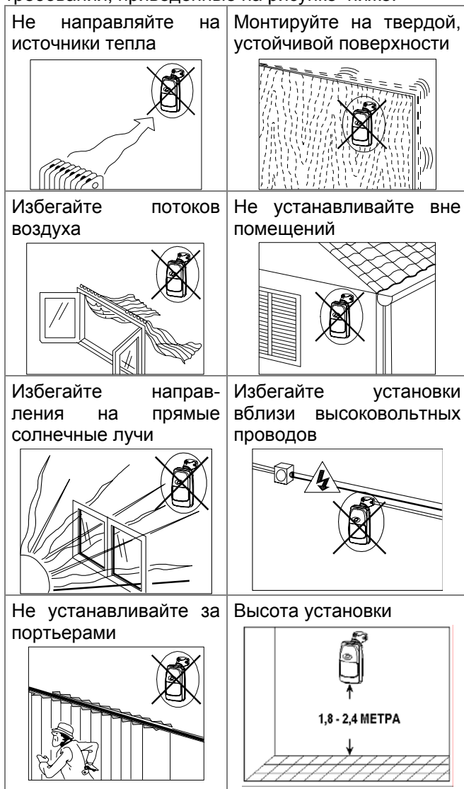
Рисунок 2. Требования к установке детекторов
