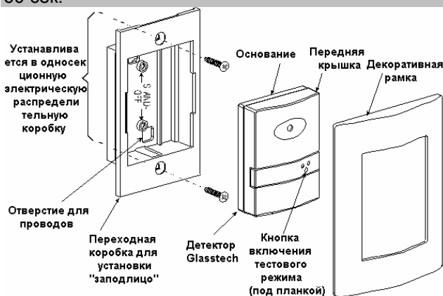
Рисунок 3. Детекторы GlassTech-F и –AM/F. КОНСТРУКЦИЯ И СБОРКА.
